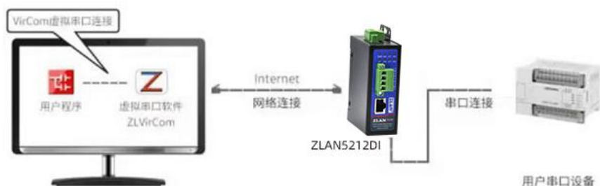
图 17 虚拟串口的作用
